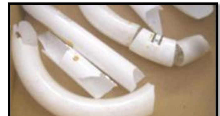
割れた蛍光灯
