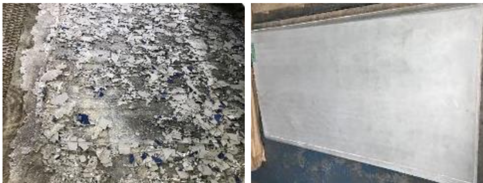
図表 43 熱分解後のパネル外観
